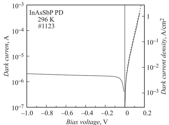
**Рис. 2.** ВАХ ФД при комнатной температуре. Штриховая линия — функция  $I = I_0(\exp(eV/\beta kT) - 1)$ , где  $e$  — заряд электрона,  $V$  — приложенное смещение,  $k$  — постоянная Больцмана,  $T$  — температура,  $\beta$  — фактор идеальности ВАХ,  $I_0$  — константа.
