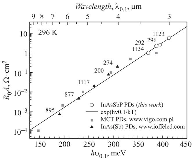
**Рис. 5.** Зависимость произведения сопротивления в нуле смещения на площадь диодов при комнатной температуре в настоящей работе и из литературных данных от энергии длинноволнового края фоточувствительности.
