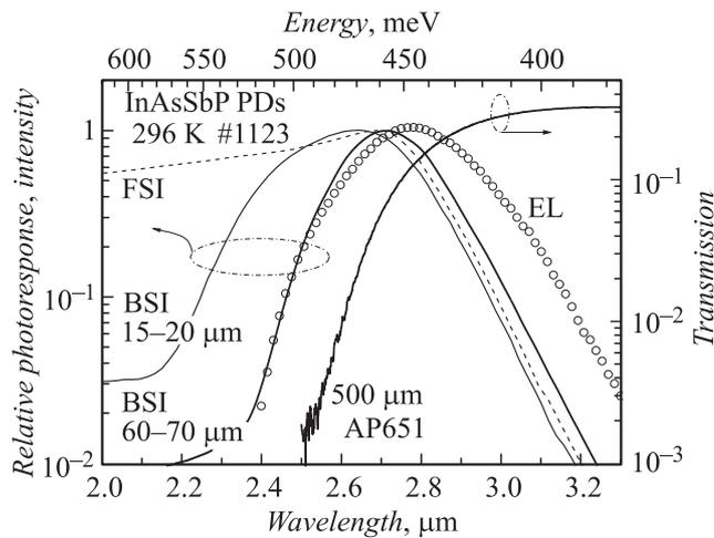
**Рис. 4.** Спектральные зависимости относительной фоточувствительности ФД с подложкой толщиной 400 (FSI), 60–70 и 15–20  $\mu\text{m}$  (BSI), а также спектр электролюминесценции ФД (левая шкала) и пропускания подложки толщиной 500  $\mu\text{m}$  (правая шкала).
