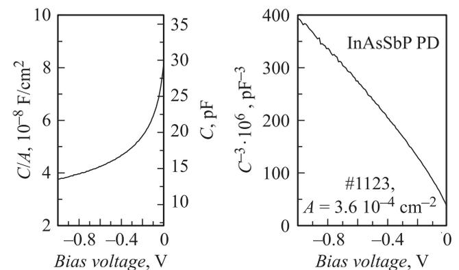
**Рис. 3.** Вольт-фарадная характеристика ФД при комнатной температуре и частоте модуляции 2 МГц.
