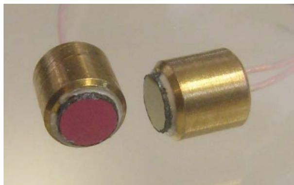
Свето- и фотодиоды могут быть укомплектованы интерференционными фильтрами. Преимуществом такой сборки является стабильность формы спектрального распределения излучения/фоточувствительности от температуры.
